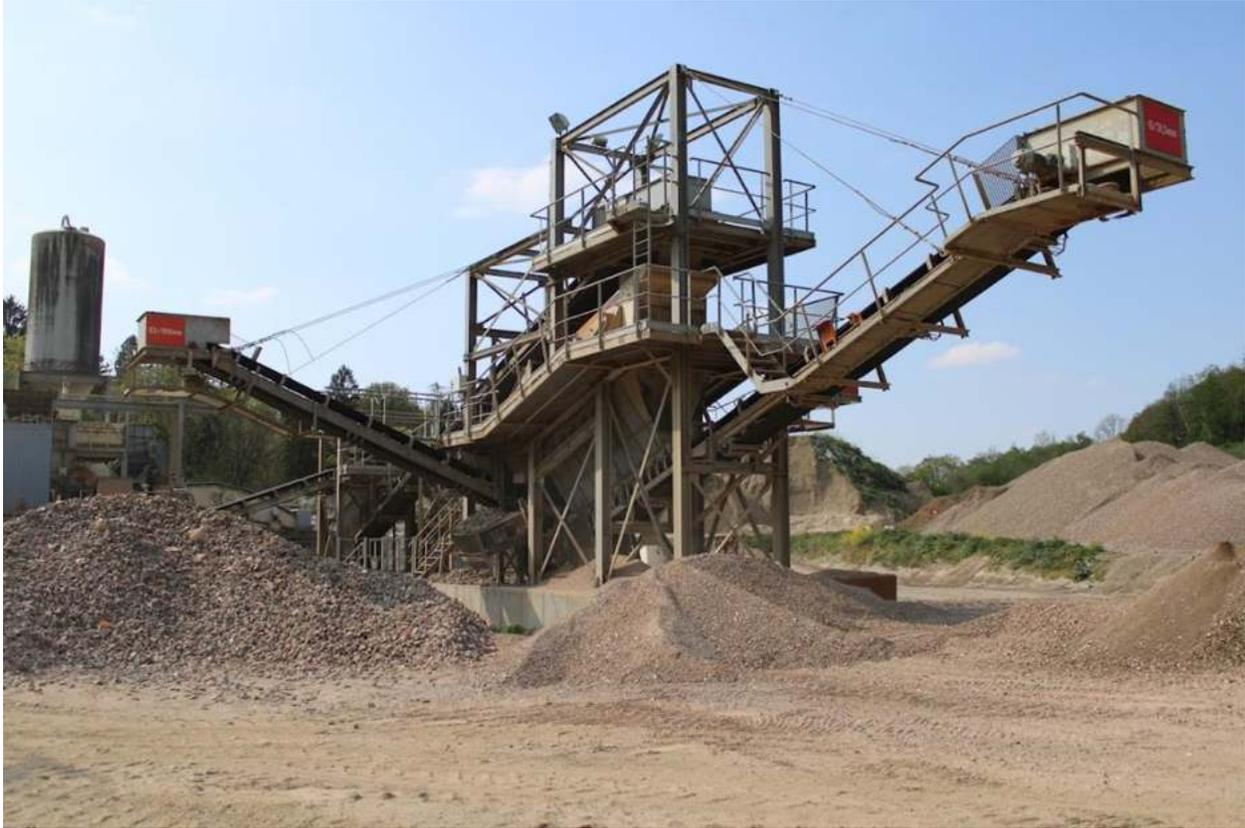
*Installations de criblage qui sépare les granulats recyclés en fractions différentes.*
