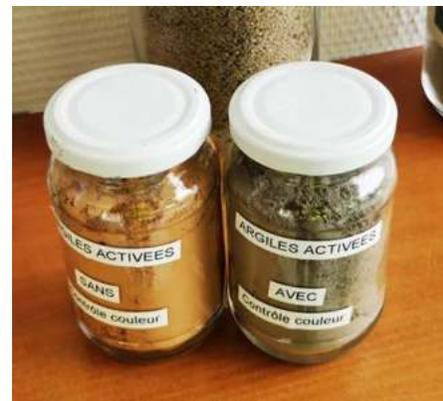
*Pour éviter la coloration du ciment par l'argile calcinée qui contient l'oxide de fer rouge, l'argile passe par la procédure de réduction pendant la calcination.*
