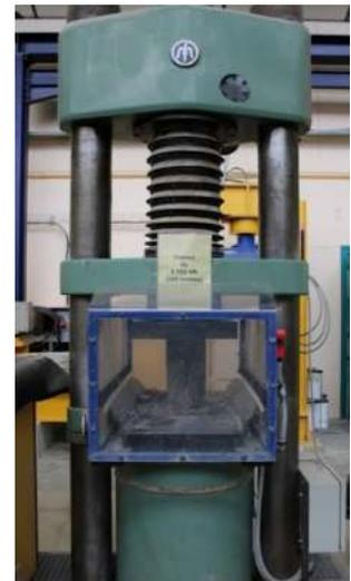
*Presse hydraulique pour mesurer la résistance à la compression du béton.*
