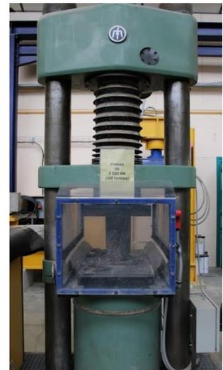
*Hydraulische Presse zur Messung der Druckfestigkeit von Beton.*
