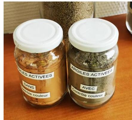
*Um eine Verfärbung des Zements durch den gebrannten Ton, der das rote Eisenoxid enthält zu verhindern, durchläuft der Ton während des Brennens das Reduktionsverfahren.*
