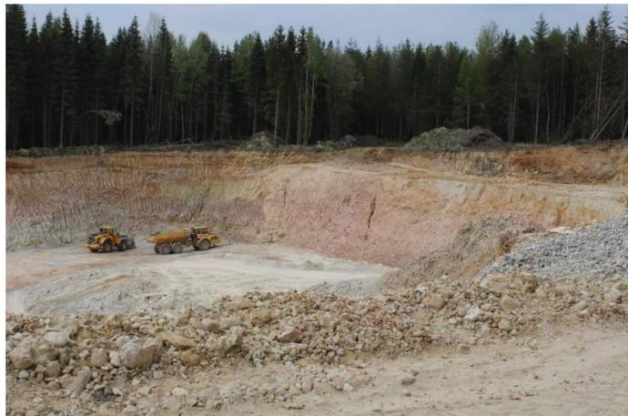
*Steinbruch für den Abbau von Quarzkies in Landscheid. Die Schichten des toten Bodens haben unterschiedliche Farben, weil in den oberen Bodenschichten Eisenverbindungen vorhanden sind, die mit dem Wasser in die Tiefe dringen, aber von feinen Tonpartikeln zurückgehalten werden und nicht weitergehen.*
