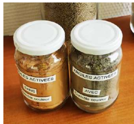
Pour éviter la coloration du ciment par l'argile calcinée qui contient l'oxyde de fer rouge, l'argile passe par la procédure de réduction pendant la calcination.
