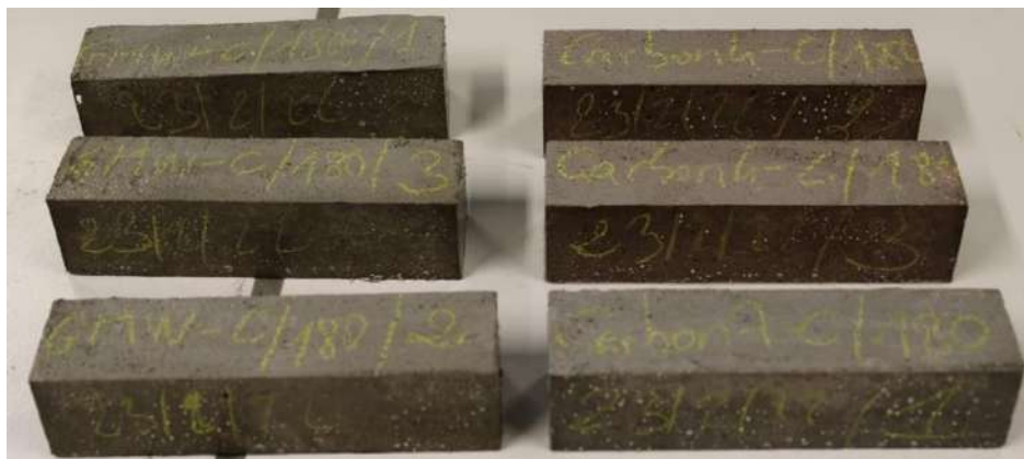
Les échantillons fabriqués dans le laboratoire des matériaux de constructions de l'Université de Liège avec les matériaux étudiés dans la cadre du projet CO2REDRES.
