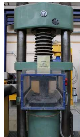
Presse hydraulique pour mesurer la résistance à la compression du béton.
