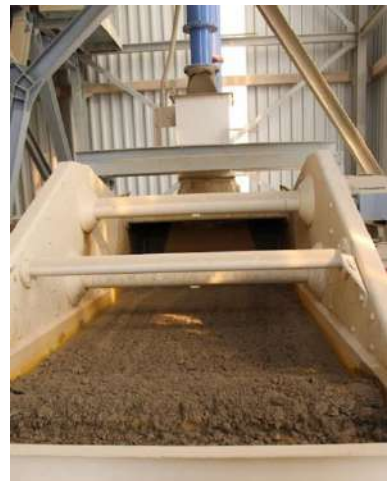
Déchet généré après le nettoyage de granulats de dolomie.
