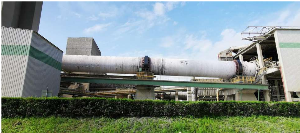
Four rotatif de la cimenterie Vicat à Xeuilley (Meurthe-et-Moselle).
